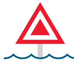
Balise de jour tribord : en forme de triangle à bordure rouge avec triangle intérieur rouge
