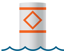
Bouée spéciale : losange orange sur bouée blanche
