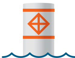
Bouée d'endroit interdit : de couleur blanche avec losange et croix oranges
